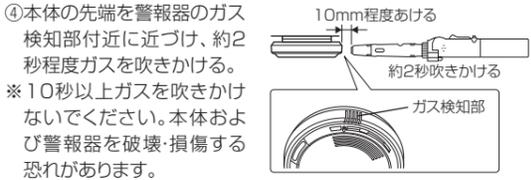
※10秒以上ガスを吹きかけないでください。本体および警報器を破壊・損傷する恐れがあります。
