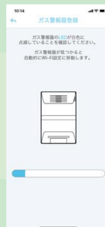
ガス警報器と接続されるまで待機 ※P5の「コネクタセンサーの利用場所確認」を行っている最中は、ガス警報器の登録はできません。 警報器の白色ランプが瞬時点滅（1秒間に1回点灯）している時は、点滅（1秒間に2回点灯）に変わるまでお待ちいただくか、電源を入れ直してください。
