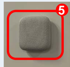
⑤リビングの壁等温度を測りたい場所に「コネクトセンサー」を貼付ける ※接着面が汚れていない事をご確認ください ※接着面に凹凸がない事をご確認ください
