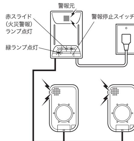
●連動接続された他の火災警報器が火災警報を発したとき、本警報器では赤スライド(火災警報)ランプが点灯し、警報音が鳴ります。
