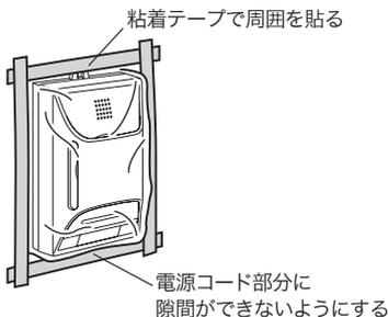
電源コード部分に隙間ができないようにする
