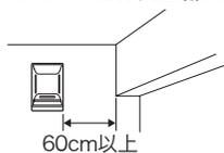
**取付例** ※天井面に接近して取り付けると、天井面が黒ずむ場合があります。
