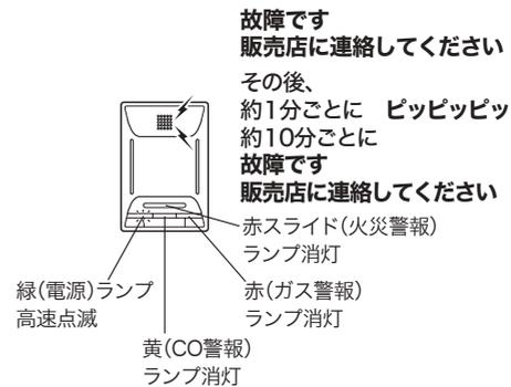
ただし、警報停止スイッチを押すと、警報音は約36時間停止します。
