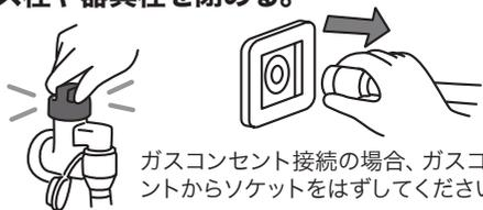
ガスコンセント接続の場合、ガスコンセントからソケットをはずしてください。
