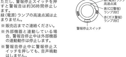
ただし、警報停止スイッチを押すと警報音は約36時間停止します。緑(電源)ランプの高速点滅は止まりません。
