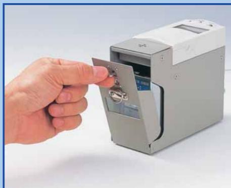
側面のセンサユニットカバーを開けます。
