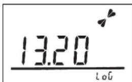
左端から入力桁が\_（点滅）します。点滅中に UP、DOWN スイッチ (▲▼) で数字を選択し、特殊スイッチで決定します。決定するとつぎの桁に移動します。
