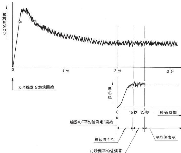
一般的にガス燃焼機器を使用した直後は、比較的高濃度のCOが発生しますが、2分ぐらい経過すれば、発生するCO濃度は傾向としてほぼ落ち着いた状態になると考えられます。しかし細かく見ると発生するCO濃度は、刻々と変動しています。
