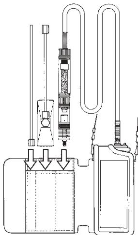
④ガス導入管を図のようにポケット側より巻き付けてください。
