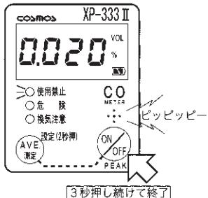
2段目警報濃度設定後、表示は新しく設定されたno.5の1段目・2段目警報設定濃度を繰り返し表示します。このときランプが同期点灯します(橙:1段目、赤:2段目)。判定ランプ点灯と共に数値を確認した後、[ON/OFF PEAK]スイッチを約3秒間押し続けてください。「ピッピッピー」音と共に電源が切れ、no.5の警報濃度設定が完了します。
