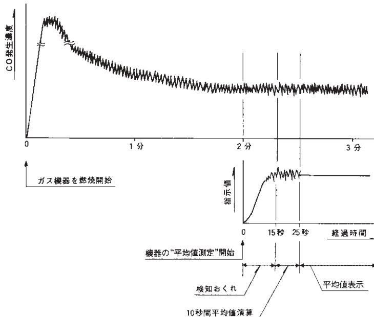
一般的にガス機器を使用した直後は、比較的高濃度のCOが発生しますが、2分ぐらい経過すれば、発生するCO濃度は傾向としてほぼ落ち着いた状態になると考えられます。しかし細かく見ると発生するCO濃度は、刻々と変動しています。
