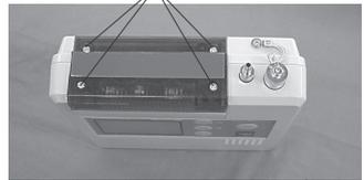
③ センサユニットをガス検知器から取り外します。
