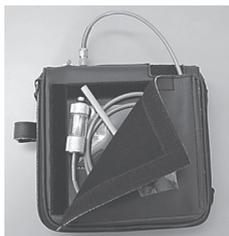
ガス導入管と吸引パイプは背面のポケットに収納できます。
