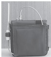
ガス導入管を収納したまま、ドレンフィルタを側面に固定した状態でも使用できます。
