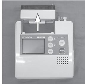
④ センサユニットの裏側の取付ネジ（2本）を緩めて外します。
