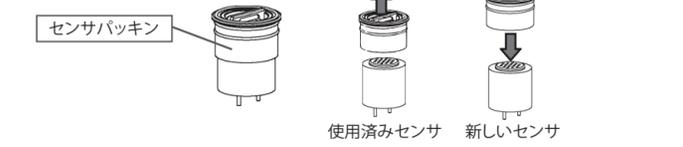
⑥ センサのピンの位置(非対称)を合わせて、センサの底面がケースの基板に当たるまで押し込みます。
