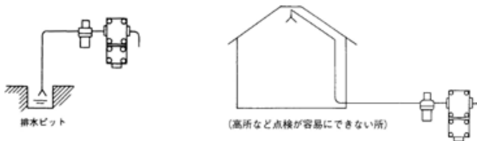
図1 2 吸引式ガス検知部の取付位置例
