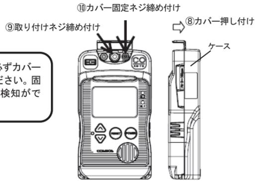
**△注意** カバーを閉じた後は、必ずカバー固定ネジで固定してください。固定していないと正しい検知ができません。
