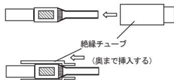
**メモ** 絶縁チューブは棒端子に奥まで挿入してください。奥まで挿入しないと端子台に接続した際に挿入長さが短くなり、接続不良となる恐れがあります。
