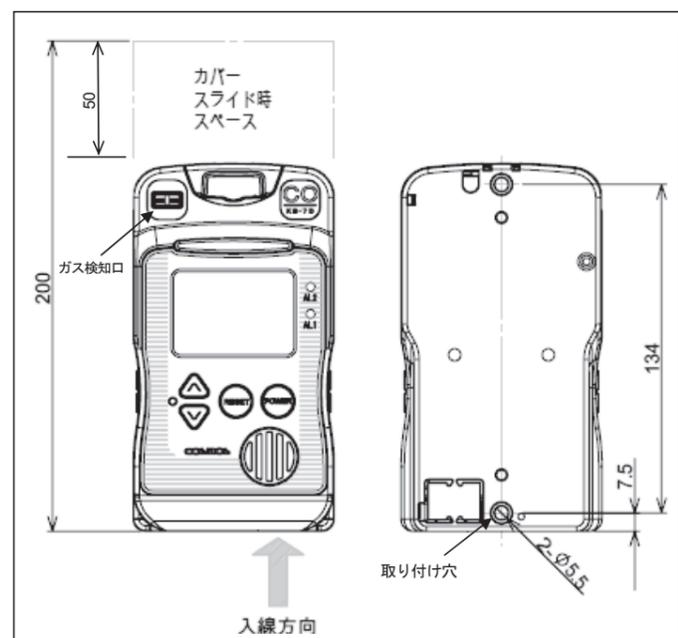
●取り付けネジ用のM5メネジ（2箇所、ピッチ134）を設け、下記の手順で取り付けます。
