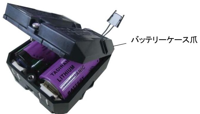
⑤バッテリーケース固定ねじを約 0.7N·m のトルクで締めてください。
