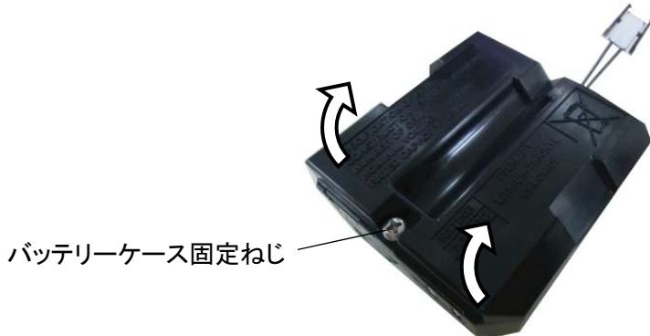
② 古い電池を取り外します。電池のマイナス側を押し上げることで、電池を取り外すことができます。
