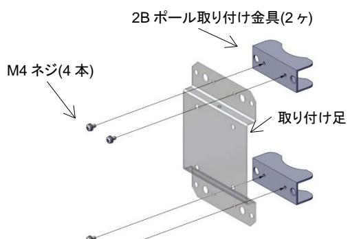
①M4 ネジで 2B ポール取り付け金具と取り付け足を固定してください
