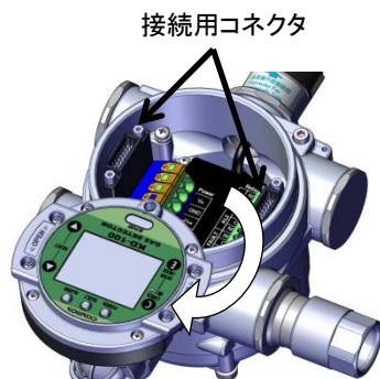
⑥ケーブルルグランドの先端部品を緩めて配線用ケーブルを通してください。
