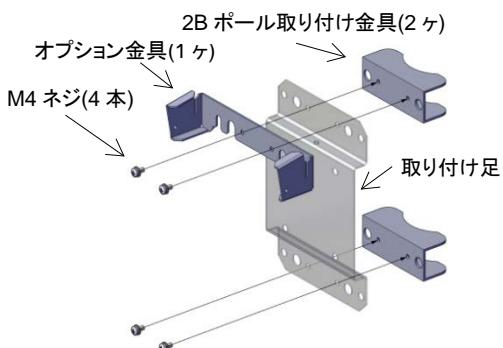
①M4 ネジで 2B ポール取り付け金具と取り付け
