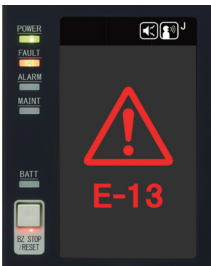
故障時 画面表示:エラーコードと ガス濃度の交互表示※ [FAULT]LED:点灯
