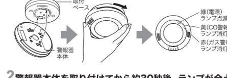
2 警報器本体を取り付けてから約30秒後、ランプが全点灯した後、消灯します。
