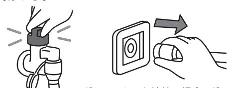
ガスコンセント接続の場合、ガスコンセントからソケットをはずしてください。
