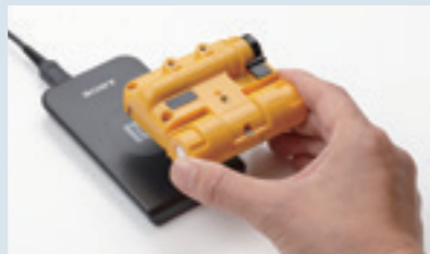
検知器をカードリーダーにかざし専用ソフトのスタートボタンを押すだけ
