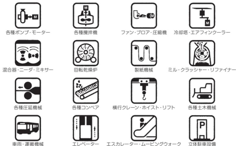
図6 グリース鉄粉濃度計の用途例
