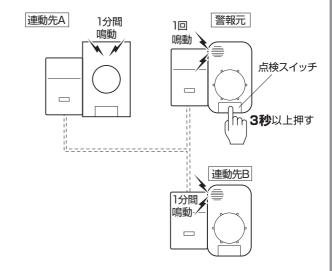
■警報を早く止めたいとき 警報元の警報器の点検スイッチを再度押すと、 すべての警報が停止します。
