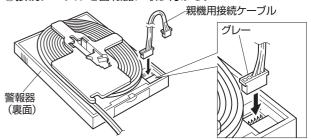
②接続ケーブルを連結板に通し、連結板を警報器に取り付ける。
