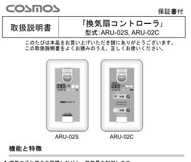
◆ 空気の汚れ度合を監視しながら、換気量を制御します。 「換気扇コントローラ」ARU-02シリーズは、ヒトの呼気や生活にともなって発生 するさまざまなガスやニオイを、空気汚れセンサで検知し、空気の汚れ度合に応 じて接点を開閉するスイッチです。ARU-02シリーズを換気扇に接続すると、換 気扇のON/OFFまたは強/弱運転<sup>※1</sup>を、空気の汚れ度合に応じて自動的に切り換え、 効率よく換気することができます。外部制御入力機能付きの換気扇に連動させて ご使用ください。
