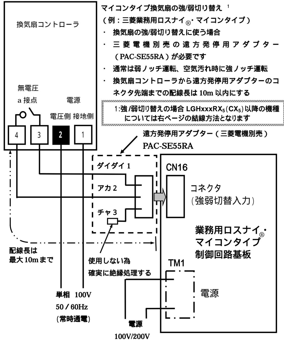
: 1 台の換気扇コントローラで複数台の換気扇をコントロールする場合、夫々の CN16 は補助リレーを使って独立した接点で制御してください
