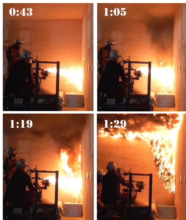
図4 ウレタン火災の時間経過。まだあまり煙が出ていない（0:43）頃にCOを検知した。
