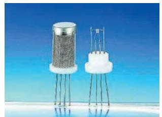
白金薄膜のヒーターと電極を備えたセラミックス基板上に、金属酸化物半導体層を形成した構造のセンサです。酸化物半導体表面における可燃性ガスの吸着と酸化反応に伴う電気伝導度の変化を高精度に検出します。
