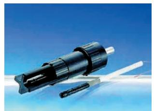
カーボンの微粒子を高分子結合剤と共にセラミックス管に塗布した構造のセンサです。油や有機溶剤の蒸気による高分子結合剤の膨潤に伴う抵抗変化を検出します。
