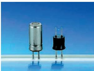
ヒーターと電極を兼ねる白金線コイル上に、金属酸化物半導体を球状に焼結させた構造のセンサです。酸化物半導体表面における可燃性ガスの吸着と酸化反応に伴う電気伝導度の変化を検出します。
