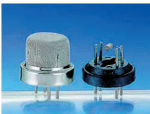
ヒーターと電極を兼ねる2つの貴金属線コイル間に、金属酸化物半導体(酸化スズ)を焼結させた構造のセンサです。酸化スズ粒子表面における可燃性ガスの吸着と酸化反応に伴う電気伝導度の変化を検出します。
