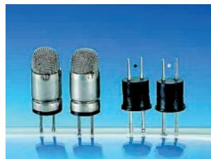
ヒーターと温度計を兼ねる白金線コイル上に貴金属触媒を球状に塗布した構造のセンサです。可燃性ガスの接触燃焼に伴う素子の温度変化を検出します。
