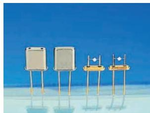
セラミックス基板上に製膜した白金薄膜ヒーターを測温抵抗体として用いる温度計測型のセンサです。気体固有の熱伝導率の違いによって生じる素子の温度変化を検出します。
