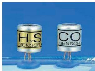
3つの電極を电解液を介して配置した構造のセンサです。ガスを一定の電位で電気分解し、その際に生じる電流を検出します。
